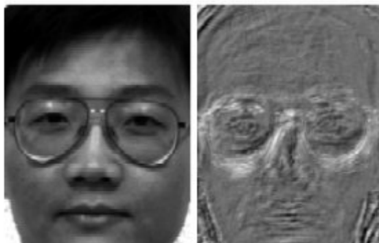
Figura 17 – Imagem Original (esquerda) e FisherFace (direita) [56].
