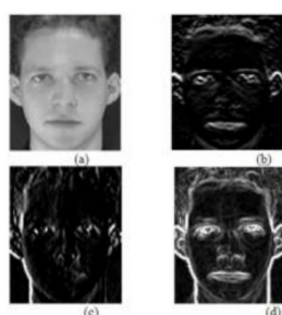
Figura 7 – (a) Imagem original, (b) Gradiente Horizontal, (c) Gradiente Vertical, (d) Gradiente Horizontal e Vertical [42].
